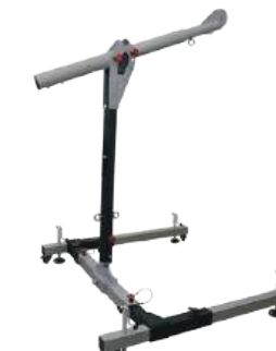
POTENCE EASYSAFEWAY 1 EN 795 B - certification directive machine - EN 1808 (exigences liées aux plateformes suspendues et réglables) - Charge MAXIMUM 500 KG - Mât dispo en 910 & 1370 mm - Base en H réglable de 1,10 à 1,50 m - 3 pré-réglages sur bras déporté.
