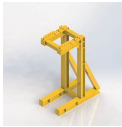
LEVAGE de coffrages de banches
