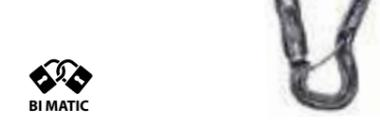
Mousqueton de sécurité, conçu pour les appareils d'assrage. Grâce à son doigt qui capture l'anneau d'assrage du harnais, tout retournement du mousqueton est impossible, le mousqueton travaille donc toujours dans le bon axe et il n'y a aucun risque d'affaiblissement de la chaîne d'assrage.
