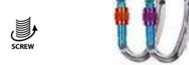
Mousqueton compact à vis particulièrement adapté aux cordes à simple pour recevoir votre appareil d'assrage. La surface de contact a été optimisée en utilisant un profil cylindrique de 12mm de diamètre moins contraignant pour la corde, limitant son usure lors des descentes en moulinette et facilitant son coulissement au moment de donner du mou.
