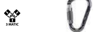
Mousqueton de relais HMS de grande capacité avec verrouillage triple action (3 MATIC), il est particulièrement adapté aux manœuvres de cordes à double (cabestan et demi-cabestan).
