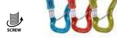
Mousqueton de sécurité à vis unidirectionnel, conçu pour les appareils d'assrage. Grâce à son doigt qui capture l'anneau d'assrage du harnais, tout retournement du mousqueton est impossible, le mousqueton travaille donc toujours dans le bon axe et il n'y a aucun risque d'affaiblissement de la chaîne d'assrage.
