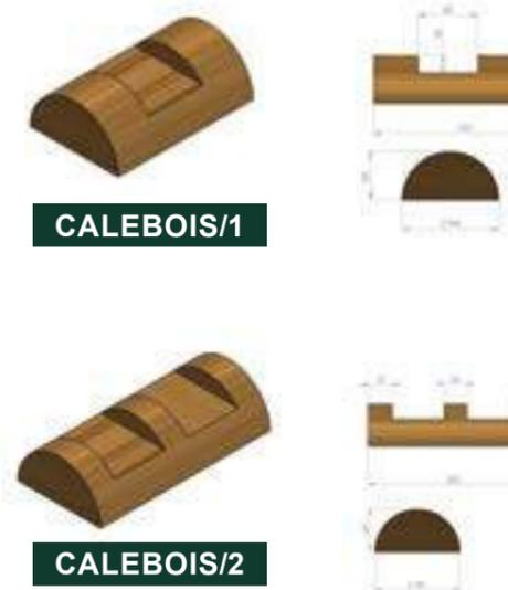
Les cales en douglas sont de petits éléments en bois massif, utilisés dans la construction et la maintenance des parcs acrobatiques en hauteur (PAH) pour ajuster, stabiliser et protéger les structures en bois ou les ancrages sur arbre.
