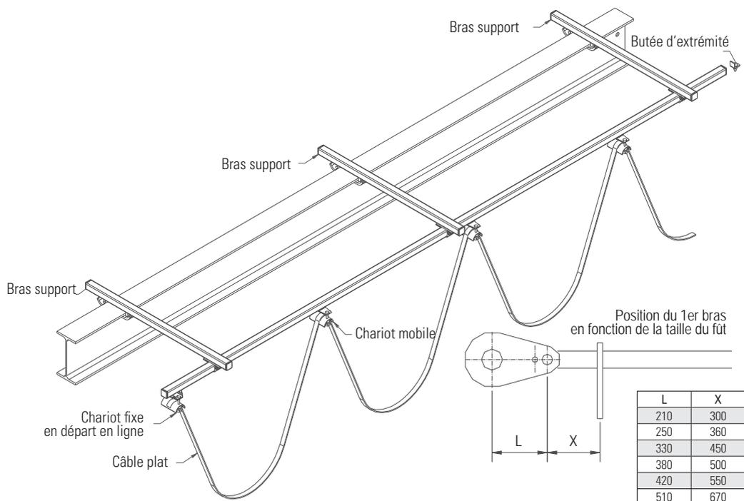
1. Disposer le 1<sup>er</sup> bras suivant la position X du plan ci joint.
