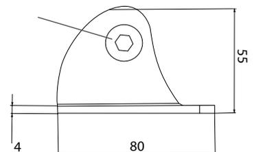
Fixation par l'intermédiaire de 12 vis autoforeuses Drillnox 5.5 par 80mm
