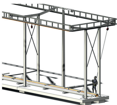
Portique de 140 ml en rail Acier galvanisé
