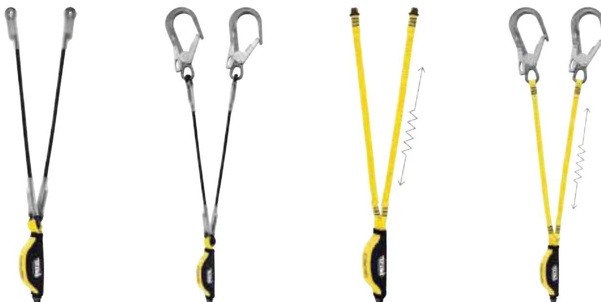
Longe double, avec absorbeur d'énergie compact et intégré, conçue pour l'assurage permanent avec passage de fractionnements. Elle est disponible en version 80 ou 150 cm (hors connecteurs). Les brins de la version de 150 cm sont élastifiés afin de ne pas entraver la progression. Disponible avec ou sans connecteurs à grande ouverture MGO, elle est certifiée selon les normes européennes et russes.
