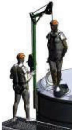
L'objectif de ce type de sécurisation est à la fois de stopper la chute, et de permettre la récupération des personnes, par l'intermédiaire d'une potence et d'un antichute à récupération.
