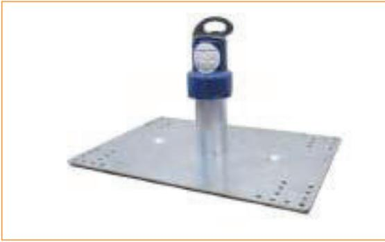
**LA POTELET D'ANCRAGE SUR BAC ACIER VECTA-SAFE®** est utilisé sur structure légère déformable. Son support possède un pré-perçage défini dans le sens des ondes du bac acier pour faciliter sa fixation. Le potelet est compatible sur bac acier de toiture avec entraxe 250 ou 333 mm dont l'épaisseur minimum est 63/100ème.
