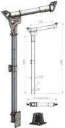
L'INTERFACE D'ANCRAGE SL2000 permet de positionner un ancrage à une hauteur de 2400 mm par rapport au sol avec un déport de 800 mm (cette côte peut être augmentée à 950 mm). Ce produit permet d'améliorer le facteur de chute, Il est donc utile pour la sécurisation des postes de travail présentant un faible tirant d'air.
