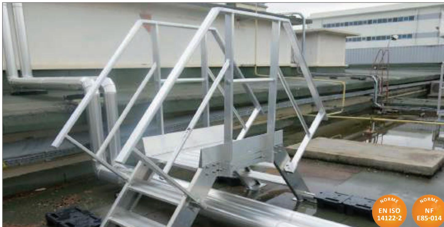
**LA PASSERELLE DE FRANCHISSEMENT VECTAWAY®** permet de passer en toute sécurité au-dessus d'acrotyères, de gaines, d'édicules et de joints de dilatation. Cet équipement est disponible en 6 modèles standards avec un escalier de 1 à 6 marches et une passerelle de 1010 mm de longueur. Le nombre de marches de part et d'autre de la passerelle peut être différent (ex : 2 et 4 marches). Nous réalisons la fabrication sur-mesure pour adapter la passerelle à divers types de structures.
