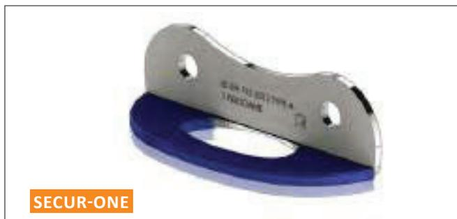
**LES POINTS D'ANCRAGE S-ONE ET SECUR-ONE®** s'adaptent à tout type de structure: béton, pierre, structure métallique, etc. La grande ouverture de ces ancrages antichute permet de se reprendre même avec une perche. Le point d'ancrage S-ONE doit être utilisé par paire uniquement. Le point d'ancrage SECUR-ONE peut être brider directement sur un structure métallique grâce à une contre-platine.
