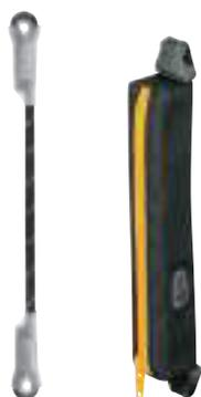
Longe non réglable en corde dynamique permettant de composer, avec un absorbeur d'énergie ABSORBICA, une longe absorbeur d'énergie en I ou en Y, tout en maintenant le connecteur en position et en protégeant les terminaisons de l'abrasion.
