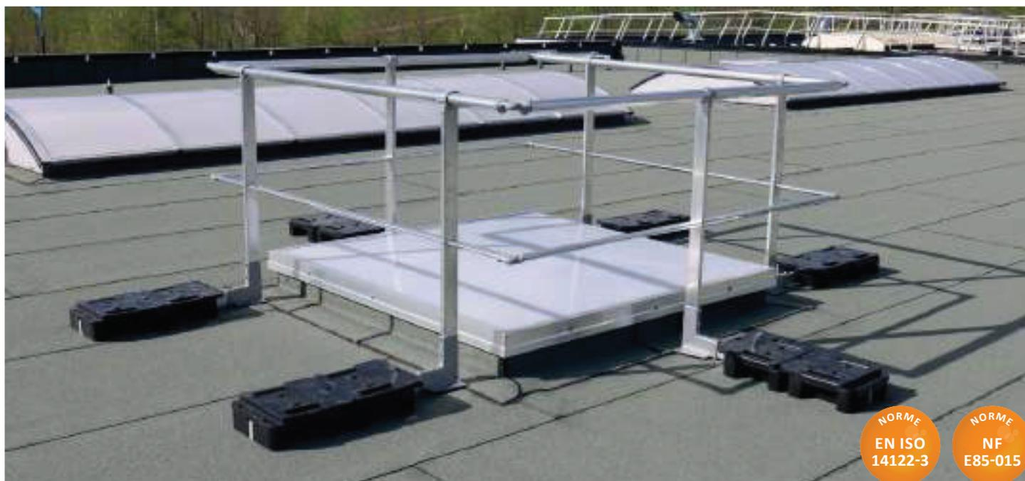
LA PROTECTION DE LANTERNEAU VL VECTACO® permet une protection périphérique de tous les types de lanterneau. Cette structure autoportante évite toute intervention de perçage sur la toiture préservant ainsi l'étanchéité. Chaque montant est stabilisé par deux plots plastique avec semelles clipsées sous les embases. L'équipement est livré en kit.
