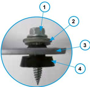
Alors qu'une vis autoforeuse standard évacue la matière du perçage en copeaux, la vis Drillnox DBS2 6x27 refoule la matière vers l'intérieur en formant un bourrelet, ce qui augmente la longueur d'implantation. Le couple de forage reste ainsi élevé même dans les petites épaisseurs (> 5 N.m contre une moyenne de 1.5 N.m pour les vis autoforeuses classiques). **Pour une fixation plus sûre, nous recommandons l'option «Douille Limiteur de Couple DB CONTROL 5N.m» (cf options).**
