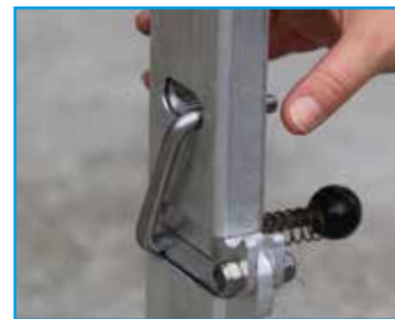
4. Enclencher la manette dans le logement en relâchant la poignée (le logement est muni de crans) de verrouillage, afin de verrouiller complètement le montant, puis pousser la manette côté extérieur jusqu'au dernier cran. Le système est alors entièrement verrouillé.
