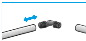
13 - Insérer les angles des lisses et des sous-lisses.
