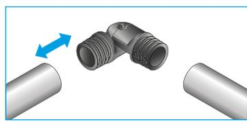
**17** - Insérer les angles des lisses et des sous-lisses.
