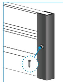
**4 -** Enfin, fixer les bouchons de plinthe avec 1 vis autoforeuse 4,8 x 16.
