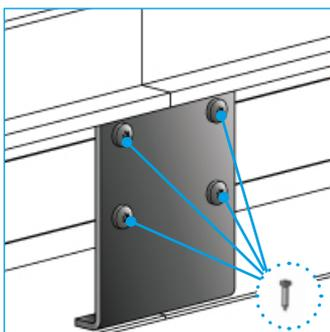
**2 -** Joindre les longueurs de plinthe entre elles grâce aux raccords de plinthe et à 4 vis autoforeuses 4,8 x 16.
