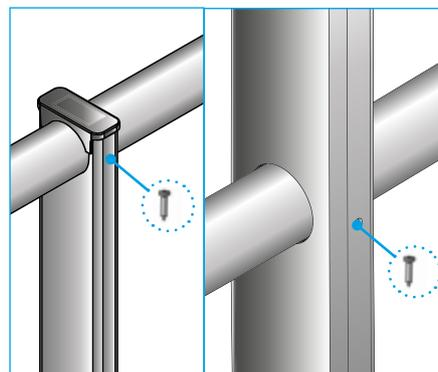
**12** - Visser les vis autoforeuses 4,8 x 25 sur le montant au niveau de la lisse et de la sous lisse
