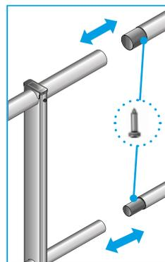
**13** - Assembler les lisses et sous-lisses des tronçons montés avec une vis 4,8 x 16
