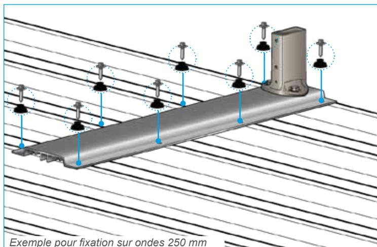
Exemple pour fixation sur ondes 250 mm
