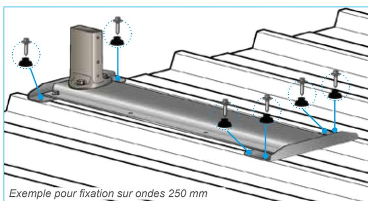
3 - Les embases ondes 250 mm et 333 mm pour garde-corps bac acier perpendiculaire au bac se fixent avec 6 vis Drillnox DBS2 avec leurs rondelles cheminées.
