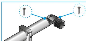
**17** - Fixer les angles avec les vis autoforeuses 4,8 x 25.
