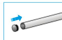
**14** - Enfin, insérer les bouchons ou les terminaisons murales aux lisses et sous-lisses.
