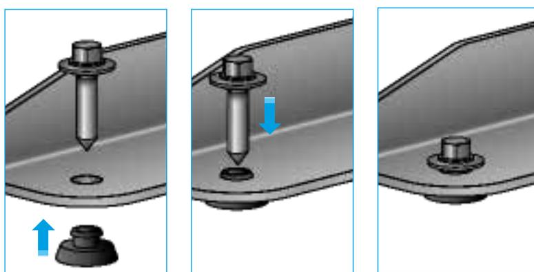
4 - Faire glisser la rondelle cheminée dans le trou par dessous la plaque, puis visser la vis Drillnox DBS2 à fond contre la rondelle pour que la fixation soit complètement étanche. Nous préconisons d'utiliser la douille limiteur de couple DB CONTROL 5 N.m (cf nomenclature page 9) pour garantir vos fixations.
