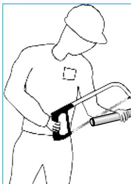
**15** - Ajuster le dernier tronçon en sciant l'excédent rétreint.
