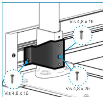
**1 -** Ôter les vis cuvettes M8x10 prémontées sur l'embase à plat et placer le support de plinthe sur l'embase. La fixer ensuite avec 1 vis autoforeuse 4,8 x 25. Puis enfin, fixer la plinthe au support avec 2 autres vis autoforeuses 4,8 x 16 (1 de chaque côté du support).
