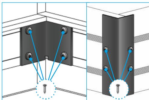
**3 -** Pour les angles, fixer les raccords intérieurs et extérieurs d'angle de plinthe avec 8 vis autoforeuses 4,8 x 16.
