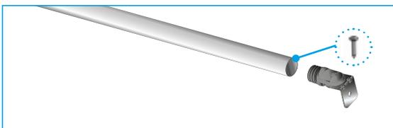
**1** - Fixer les terminaison murale à l'aide des vis autoforeuses 4,8 x 25
