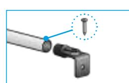
**10** - Insérer les angles des lisses et des sous-lisses.
