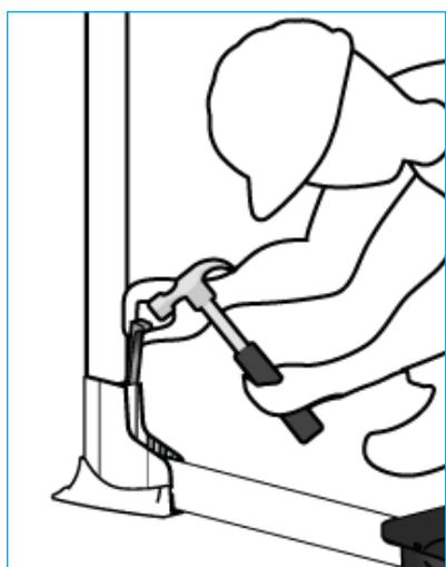
4 - À l'aide d'un marteau bloquer le coin entre le montant et l'embase.
