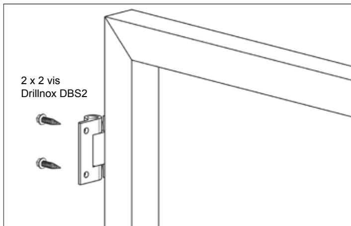
Fixer directement le portillon sur un montant de sortie de face à l'aide des 4 vis Drillnox DBS2\*.
