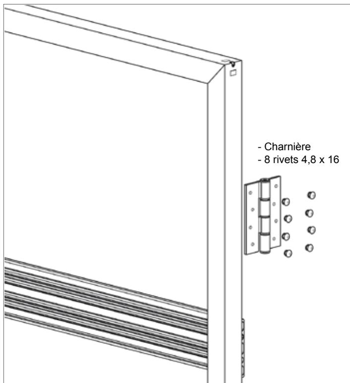
Portillon H 1100 mm : monter les charnières avec 8 rivets 4,8 x 16\* sur le montant du portillon puis fixer le tout sur un montant de la sortie de face avec 8 rivets 4,8 x 16\*. Enfin fixer la butée en caoutchouc sur le portillon.
