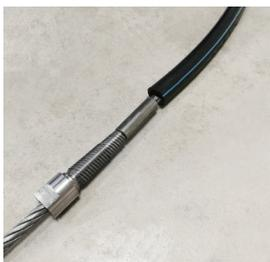
Présenter le tire PE devant le tuyau et l'insérer à l'intérieur.
